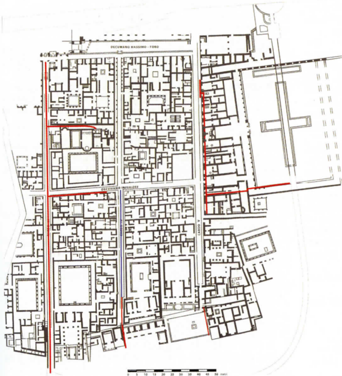
Fig. 6.23. Planimetria dell'antica Ercolano con evidenziata in rosso la rete fognaria indagata dal Progetto HCP. In blu il tratto ipotizzato sulla base delle indagini geognostiche (disegno D. Camardo).
